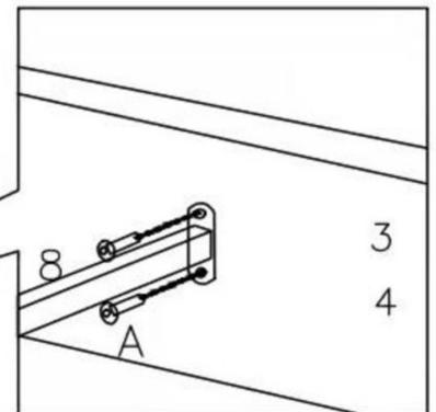
Não apertar totalmente os parafusos, uma vez que poderá ser necessário ajustes após fixada a moldura do estrado.
