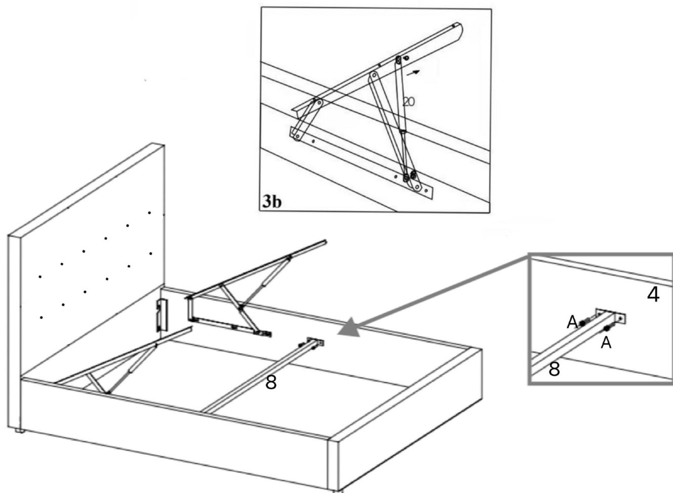
Não apertar totalmente os parafusos, uma vez que poderá ser necessário ajustes após fixada a moldura do estrado.
