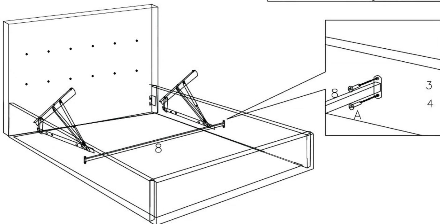
Não apertar totalmente os parafusos, uma vez que poderá ser necessário ajustes após fixada a moldura do estrado.
