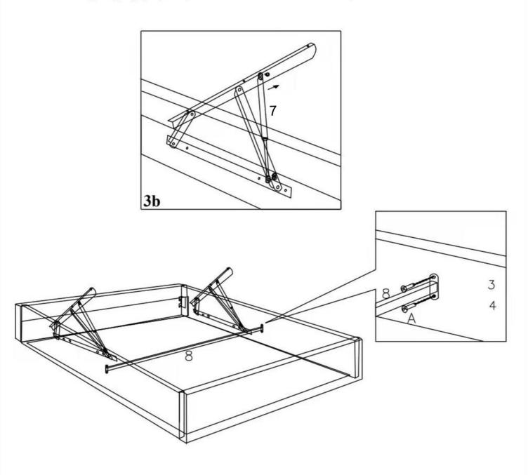
Não apertar totalmente os parafusos, uma vez que poderá ser necessário ajustes após fixada a moldura do estrado.
